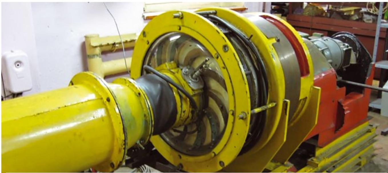
*Аэростенд для исследования структуры потока в ступенях*
